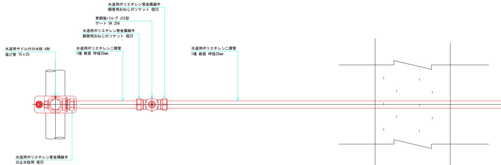
手動空気抜弁設置要領 (断面図)
