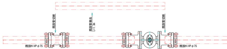
※既設管を切断撤去し、仕切弁等の布設を行うこと。
